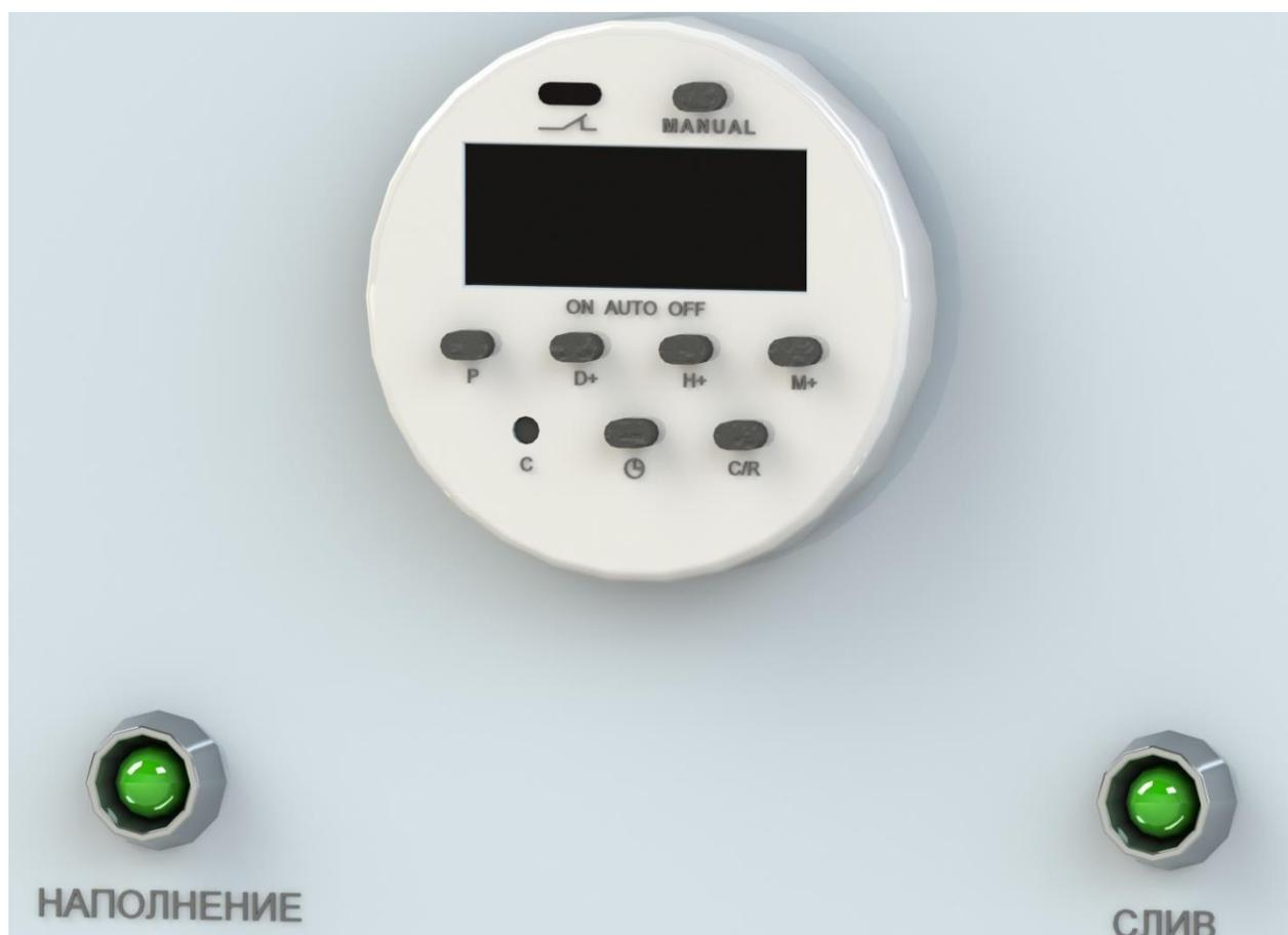
Подключите модуль управления в сеть 220V. Таймер обладает внутренней энергонезависимой памятью и для первого включения может потребоваться 5-10 минут ожидания. При помощи тонкого предмета: шариковой ручки, зубочистки ... - обнулите таймер. Для этого на 5 секунд нажмите и удерживайте защищенную кнопку “С”
